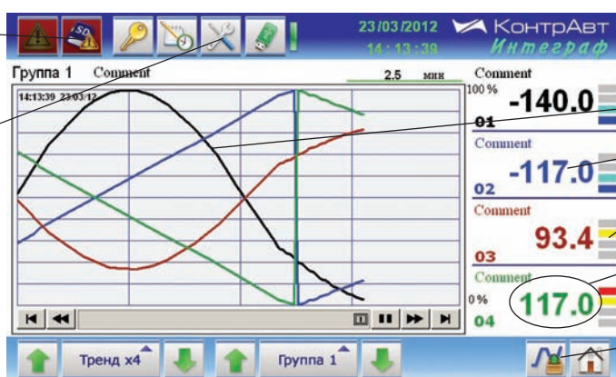
Бар-граф x4. Групповой 4-х канальный бар-граф аналоговых сигналов
