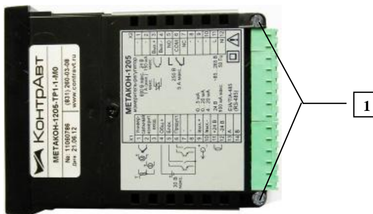
Рисунок 3 – Защита приборов МЕТАКОН серии ХХХХ от несанкционированного вскрытия с помощью поверительного клейма
