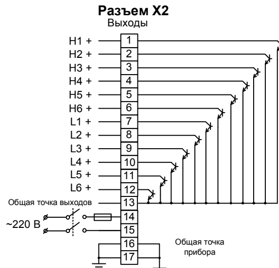
Рисунок 8 – Схемы подключения к клеммным соединителям прибора модификаций МЕТАКОН-5X2-Т-Х
