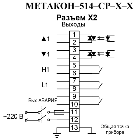
Рисунок 14 – Схемы подключения выходных цепей к клеммным соединителям для модификаций МЕТАКОН-514-CP-X-X
