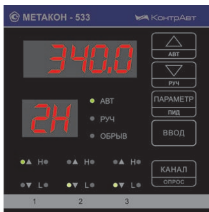
Индикаторы АВТ, РУЧ, ОБРЫВ отображают режим работы регулятора
