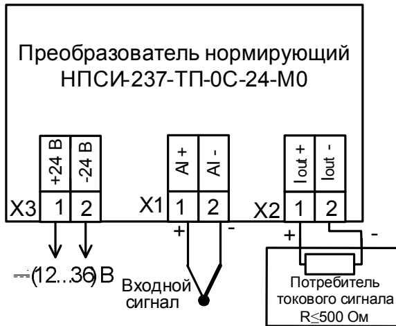
Рисунок 6 – Электрическая схема подключения преобразователя НПСИ-237-ТП-0С-24-М0
