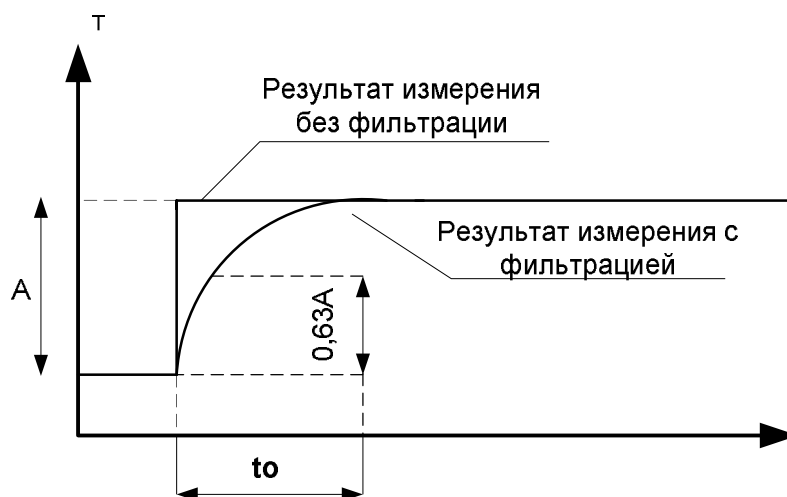
Рисунок 5 – Цифровая фильтрация результата измерения
