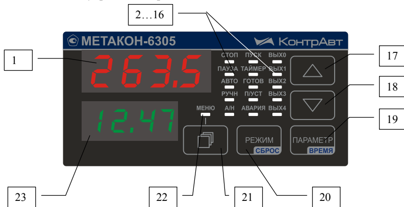
Рисунок 5.1 – Передняя панель прибора МЕТАКОН-6305
