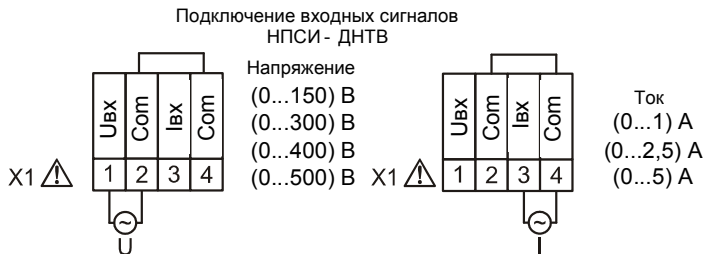
Рисунок 7а – Подключение входных сигналов к НПСИ-ДНТВ
