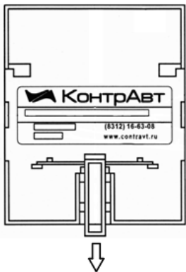
Рисунок 5 – Способ установки блоков при монтаже
